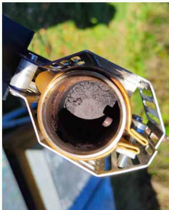
*Figure 21. Encrassement de la chambre à combustion d'un sublimox après sublimation d'Api-Bioxal®. Le saccharose présent dans l'Api-Bioxal® entraîne l'encrassement du foyer de combustion.*
